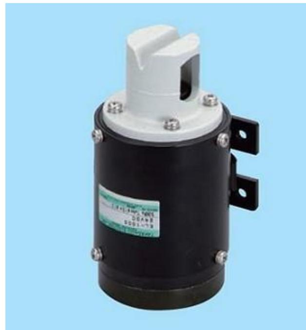
ラッチ機構を採用した、EPKシリーズ同等品（大口径シリコンチューブ用）です。バルブの開閉状態を永久磁石の磁力で保持するラッチ機構を採用することで、動作時のみに電力を消費する低消費・省電力タイプです。お客様のご使用のチューブにあわせてカスタマイズも可能です。
